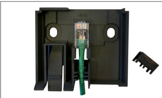
2.b. Voit liittää RJ45 liittimen suoraan kaapelin . Tätä varten toimitetaan spacer kappale.
