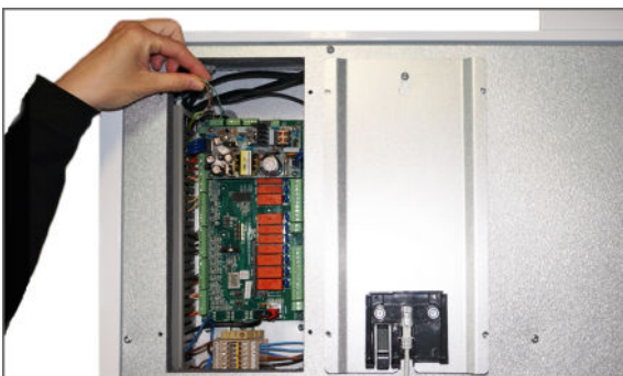
5. Irroita kosketusnäytön panelin johdot kortilta, poista seinäteline ja asenna se minne haluat kosketusnäytön.
