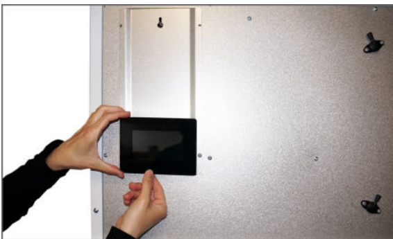
3. Irroita kosketusnäyttö painamalla pohjassa olevaa salpaa.
