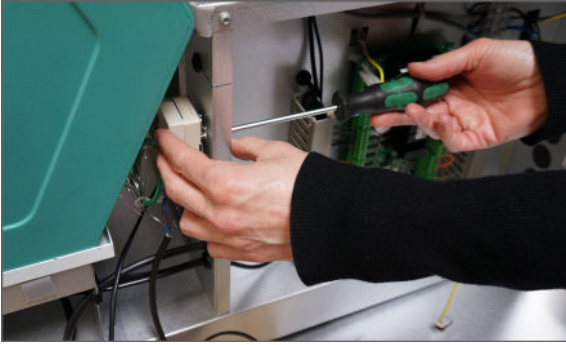
5. Asenna termostaatti (B3) sähkökytkentätilan ulkopuolelle sopiviin reikiin 2:lla ruuvilla.
