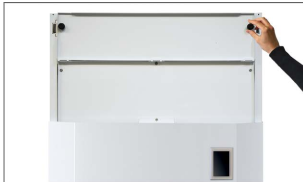
2. Irrota sormiruuvit ja poista suodatinovi. Irrota keskellä oleva ruuvi jotta saat poistettua alemman etulevyn. Irrota ruuvit ja poista kansipelti
