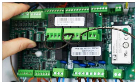
4. Paina laajennuskortti oikeaan kohtaansa pääpiirikortilla.
