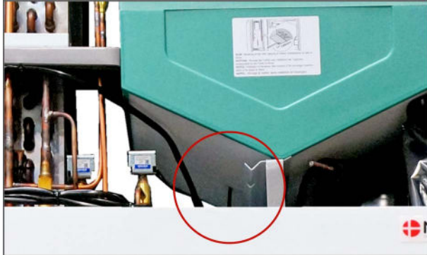
1. Poista T4 lämpötila-anturi lämmönvaihtimesta.
