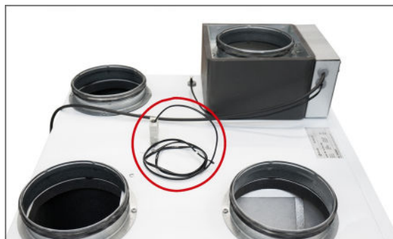
6. T1 anturi asennetaan raitisilmakanavaan noin 30 cm ennen lämmitintä.
