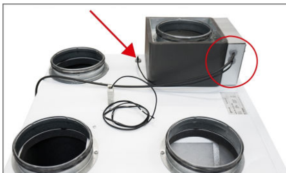
5. Esilämmittimen lämpötila-anturi työnnetään 8 cm läpi läpiviennistä. Tarkasta koneen sisältä että se roikkuu hieman raitisilmasuodattimen yläpuolella.
